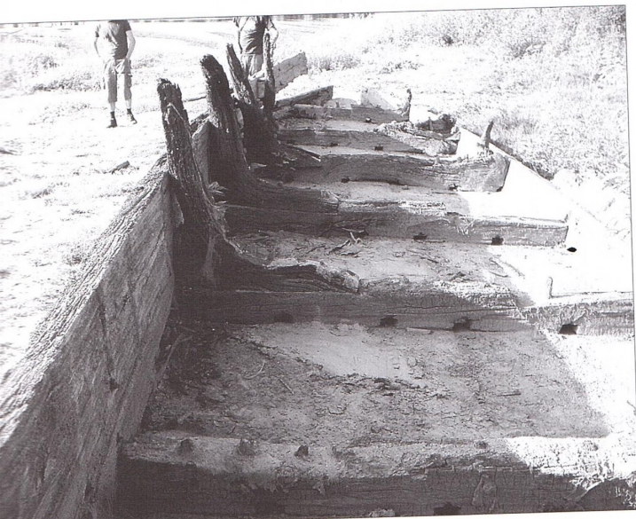
Desnos baidoko vidinė konstrukcija ir borto aukščio matavimas. Dimitrijaus Kobalijos nuotraukos.
