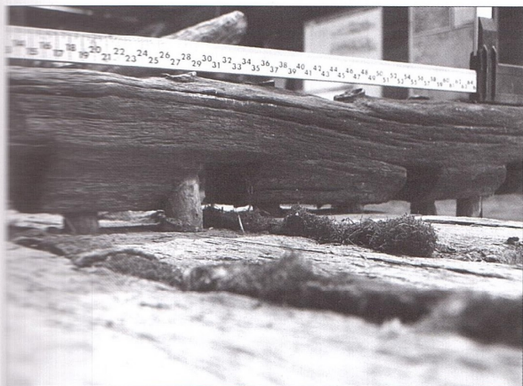
Plyšai tarp dugno lentų užsandarinti samanomis, kurias prilaiko kaltinės kabės. Aido Mozūraičio nuotraukos.
